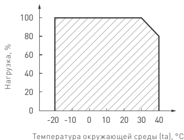
Рис. 2. Максимальная допустимая нагрузка, % от мощности источника.
