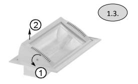
2 Снять отражатель (для моделей, у которых монтажные кронштейны крепятся на винтах):
