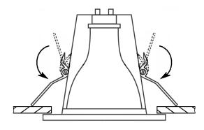
5 Установить отражатель (при необходимости), закрепив его гайкойбарашком.
