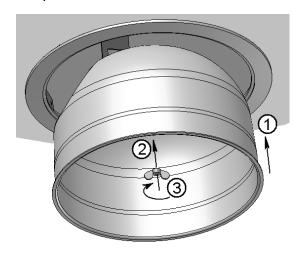
6 Вставить лампу (лампы). Затем установить решетку и рассеиватель (при наличии).
